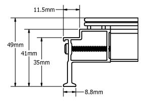
Figure 2: Long Edge Frame Detail
